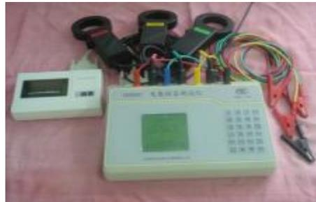
DJYC 电动机经济运行测试仪是本公司精心研制的便携式多功能电参数检测仪器，国产仪表价格，超越进口仪表功能。该测试仪可不断电在线检测用电设备和工频线路的所有电能电量参数。输入电动机空载参数和额定参数(此参数检测仪中已内存 180 大类 6900 余种，用户可选择调用特殊电动机用户可自行输入)。即可检测出电动机转轴端的输出功率、效率、负载率（符合 GB12497-2006《三相异步电动机经济运行》国家标准）。增加光电数字采样器可测量电动机的转速，用于风机各行业在生产制造中对风机功效的检测。
